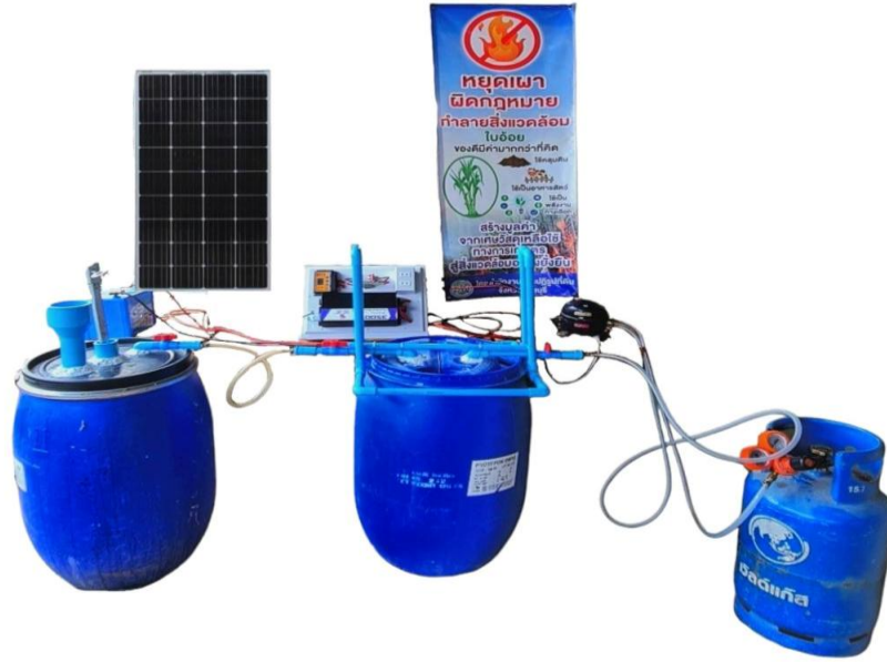
ภาพที่ 3.4 ชุดอุปกรณ์ต้นแบบสำหรับการผลิตก๊าซชีวภาพจากใบอ้อย
